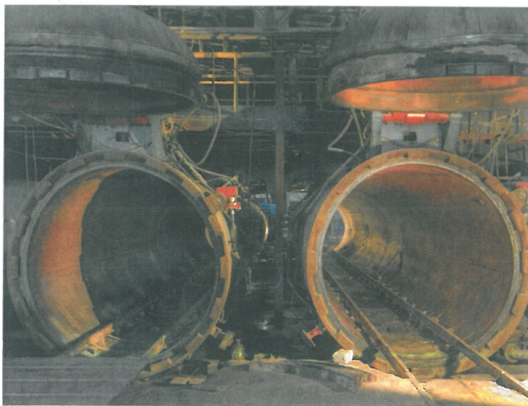
Autoklaavides valmivad kõrge temperatuuri ja rõhu all lubja, liiva ja vee segust tugevad silikaattooted
